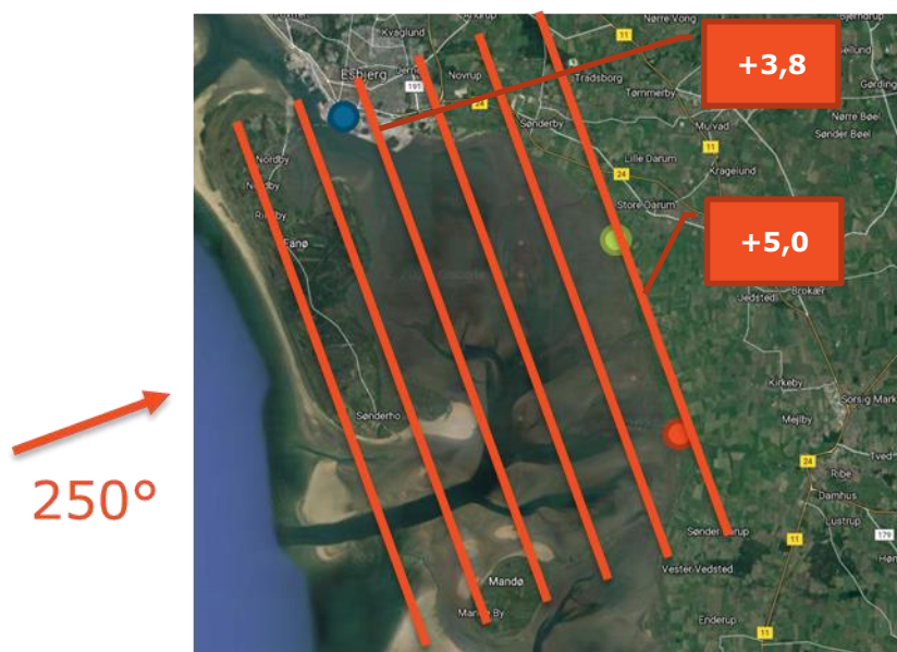
Figur 3-3 Principskitse af vindstuvning med vind fra 250°. Linjerne er "højdekonturer" som angiver samme niveau af vindstuvning. Blå markør: målinger ved Esbjerg Havn, Rød markør: målinger ved Ribe Kammersluse Grøn markør: det sydligste punkt på Darum-Tjæreborg diget.
